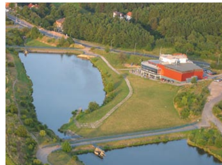
Dešťové retenční nádrže je možné realizovat i s ohledem na prostředí, do něhož jsou umístěny, jak ukazuje příklad dvou retenčních nádrží se stálým nadržněním na Košíkovském potoce (povodí 300 ha) o objemu 2 x 15 tisíc m 3 . Zdroj: SB Centrum, s. r. o.
